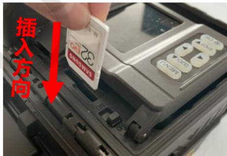
SD 存储卡的金属触点朝下，有缺角一端朝里，插入相机的左下方卡槽中，并将存储卡向里推进，直至听到“咔哒”的声音，存储卡安装完毕。
