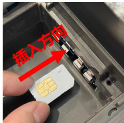
安装 SIM 卡：将 SIM 卡缺角端朝卡槽位置，金属接触面朝上，插入相机。
